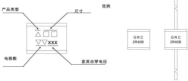
注: 适用于型号 GRC2R27B□□~GRC2R65B□□的 T=7.9±0.3mm, 打印二排
