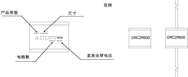
注:适用于型号 GRC2R280□□~GRC2R25B□□的 T 是 6±0.2mm 的产品,打印一排
